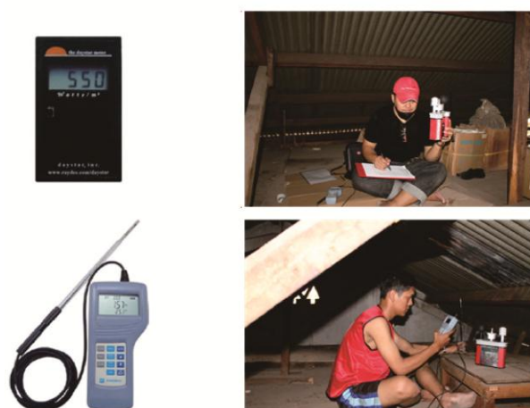
Gambar 3. Alat ukur dan pengambilan data. a). Daystar Solar Meter DS-05A; b). Kanomax A041; c). Pengambilan data termal ruang atap
